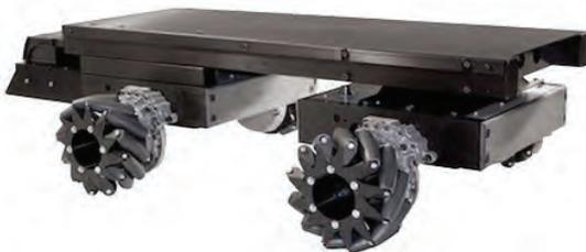
2台のコントローラで、メカナムホイールを使って4台のモータを駆動して全方向ロボットを動かすこともできます。
